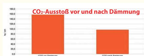
**Der Energieausweis gemäß §§ 16 ff. Energieeinsparverordnung (EnEV) beweist für den Mintarder Weg 16 vor der Dämmung einen Energiebedarf von 245,6 kWh pro qm, danach nur noch von 152 kWh. Vor der Dämmung verursachte das Gebäude CO<sub>2</sub>-Emissionen von 157,2 kg/qm, nach der Dämmung waren es hingegen 97 kg/qm.**
